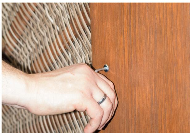
Seitenteile lösen Schritt 3: Alle übrigen Schrauben des Seitenteils vorsichtig losschrauben
