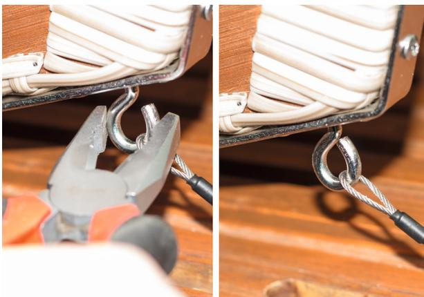
Haken am Oberkorb vorsichtig mit Zange zusammenbiegen. Seitenteile, Hand- und Verstellgriffe wieder montieren.
