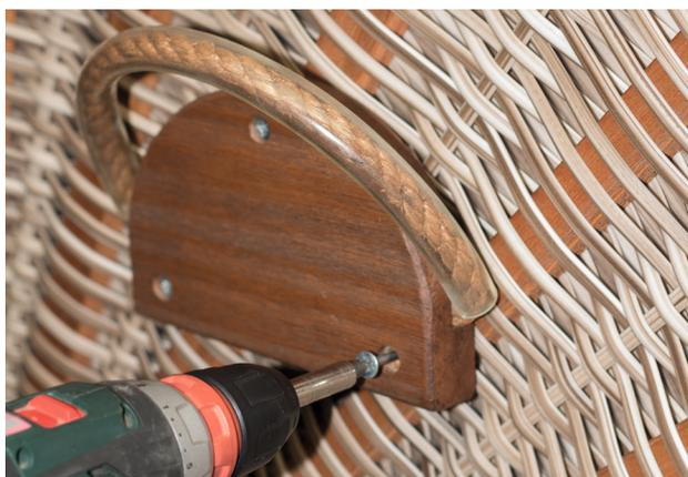
Seitenteile lösen Schritt 2: Tragegriff vorsichtig abschrauben
