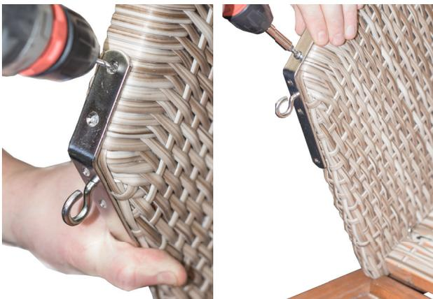
Winkel an den Oberkorb anlegen (Haken nach unten), **Löcher vorbohren (3 mm)** und anschließend festschrauben
